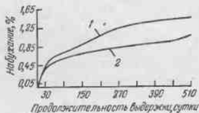
Рис. 3.11. Набухание полиэфирной смолы ПН-10 в воде (1) и в 25%-ной серной кислоте (2) [4, т. 2, с. 27].
