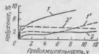
Рис. 3.8. Кинетика набухания полиарилатных пленок в бензине и трансформаторном масле: пленка Ф-2П (1, 1'), пленка Д-4П (2, 2') соответственно [4, т. 2, с. 295].
